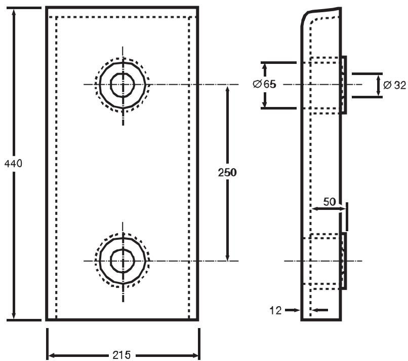
**STEELWORK FOR DOCK BUMPERS****HEAVY DUTY DOCK BUMPER FRONT/SIDE PLATES****Part Number: SP3010/SIDE - Fits DB3010**
